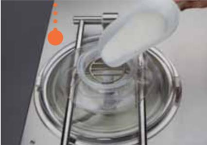
Doble tapa con mecanismo de apertura con dirección asistida por pistones hidráulicos para facilitar la introducción de los ingredientes, incluso con funcionamiento ya iniciado, sin tener que parar la máquina, en el pleno respeto de las normas de seguridad certificadas por CE.
