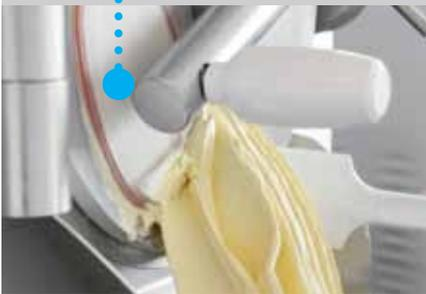
Es posible seleccionar la gestión automática de la extracción del helado mediante la variación automática de la velocidad de rotación del agitador, manteniendo la resistencia al derretimiento desde el inicio hasta la terminación de la fase de extracción. Las progresiones de las velocidades se personalizan y esta solución ofrece una gran practicidad en la extracción de los gustos con agregado de aderezos.
